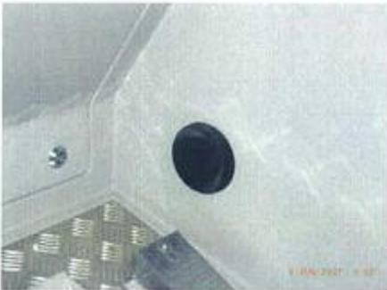
Bei den verstellbaren Ausblaslamellen bei der Stirnscheibe ist zu achten, dass alle offen und gerade nach oben ausblasen können, da sonst bei starker Sonneneinstrahlung die Wärme nicht von der Scheibe weggebracht wird.
