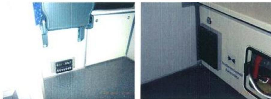
Sollte die kalte Luft an der linken Seite nach vorne ausblasen, kommt es zum Lüftungskurzschluß.
